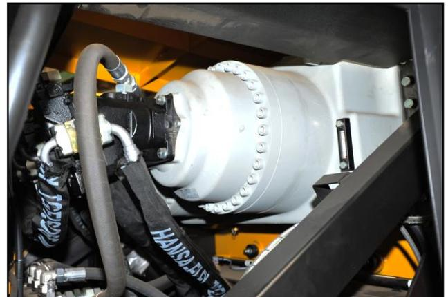
Гидравлические моторы в свою очередь имеют соединение с рабочими валами через трехступенчатый планетарный понижающий редуктор.
